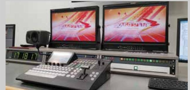
Основными рабочими инструментами режиссеров, являются видеомикшеры Panasonic: 32-входовой 2ME в основной аппаратной и компактный (12 входов) микшер в новостной АСБ.
