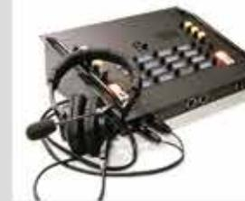
Служебная связь реализована на базе оборудования Riedel и состоит из двух блоков: связь аппаратной с учебными классами и отдельная система связи режиссер — звукорежиссер — операторы.
