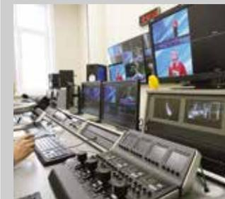
Цветоустановка и управление диафрагмами камер осуществляется с рабочего места инженера в аппаратной, оснащённого АТЕМ Camera Control, опорным монитором Oris и векторскопом.
