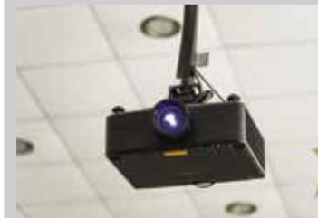
Из-за ограниченных возможностей монтажа проектор расположен на расстоянии более 12 метров от экрана, но длиннофокусный объектив легко решает эту проблему.
