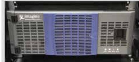
Система Imagine Communications ADC позволяет автоматизировать работу большого количества устройств комплекса, основываясь на подготовленном расписании для каждой зоны вещания.
