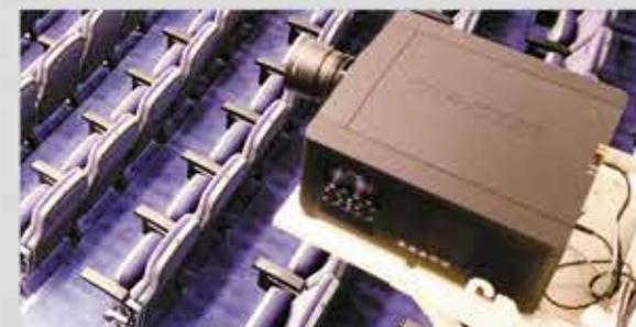
Проекция на большой экран осуществляется с помощью широкоформатного проектора Christie HD10K-M, оснащенного входным интерфейсом HD-SDI.
