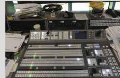
Видеомикшер Gigatex GVM-2425 позволяет формировать две программы с резервированием ключевых элементов тракта.
