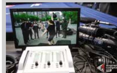
Комментаторский блок AEQ Olympia подключен к звуковому тракту посредством протокола Dante.
