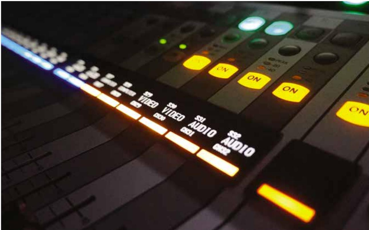
ИНТЕРЕСНОЙ ОСОБЕННОСТЬЮ ЗВУКОВОГО ТРАКТА ЯВЛЯЕТСЯ РАБОТА В ПОЛНОСТЬЮ ЦИФРОВОМ РЕЖИМЕ, ПО ПРОТОКОЛУ DANTE — СИГНАЛ ПРЕОБРАЗУЕТСЯ В АНАЛОГОВЫЙ ТОЛЬКО ОДИН РАЗ, В УСИЛИТЕЛЕ МОЩНОСТИ
