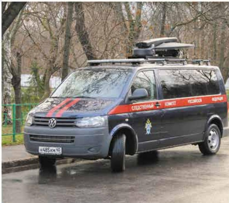
Станция предназначена для обеспечения трансляций цифровых ТВ-сигналов через геостационарные спутники связи в Ku-диапазоне.
