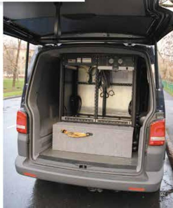
Автомобиль состоит из трех отсеков: водительского, технологического и транспортного. В технологическом отсеке расположены стойки для размещения оборудования. Имеется надежная защита рабочего отсека от несанкционированного прослушивания. Для коммутации внешних линий предусмотрен лючок по левому борту. Автомобиль оснащен кондиционером технологического
