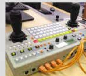
Многофункциональный пульт Panasonic AW-RP655L обеспечивает ввод в память и вызов из нее до 50 положений поворотного устройства.
