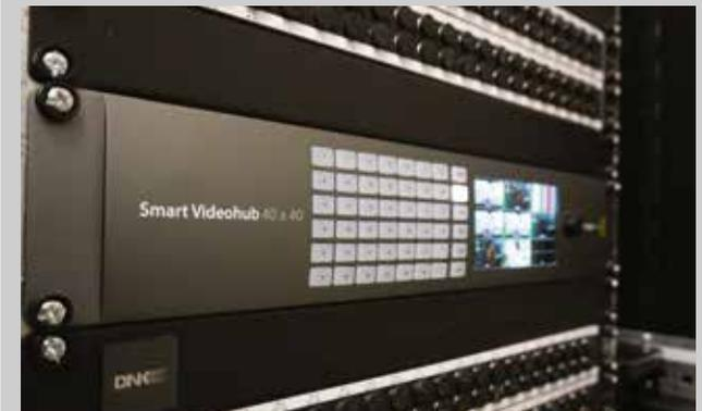
Коммутационным ядром видеотракта является Videohub 40x40, подключенный к оборудованию как АСБ, так и эфирного комплекса. Однако авария коммутатора не влияет ни на непрерывность вещания, ни на подключение камер и плееров к видеомикшеру АТЕМ 2 М/Е. В то же время, микшер резервирован самим матричным коммутатором.
